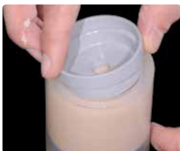
Riempire il cilindro fino alla demarcazione ed applicare il calibro (coperchio) per cilindro IPS con un movimento d'inclinazione. Premere il calibro del cilindro fino all'arresto nell'anello in silicone. Le eccedenze di rivestimento fuoriescono dall'apertura. Lasciare indurire senza vibrazioni il cilindro della messa in rivestimento
