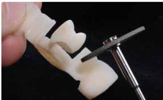
Separare i canali di pressatura con disco per separazione in caso di restauri policromatici.
