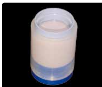
Riempire il cilindro fino alla demarcazione ed applicare il calibro (coperchio) per cilindro IPS con un movimento d'inclinazione. Premere il calibro del cilindro fino all'arresto nell'anello in silicone. Le eccedenze di rivestimento fuoriescono dall'apertura. Lasciare indurire senza vibrazioni il cilindro della messa in rivestimento
