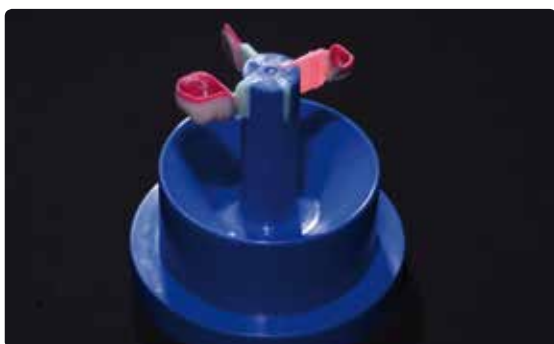
Base per cilindro IPS Multi pronta con modellazioni impennate.
