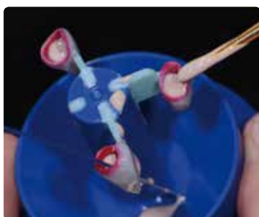
Riempire di rivestimento le cavità con uno strumento idoneo (p.es. pennello).
