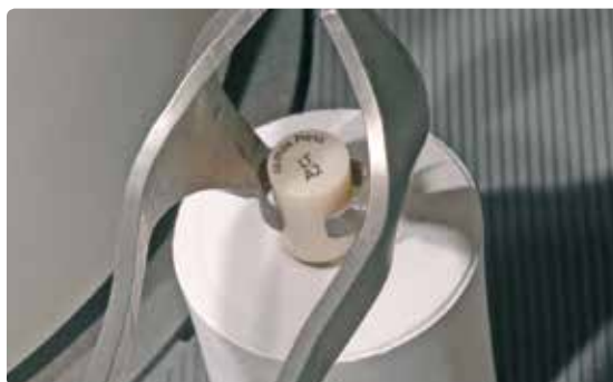
Posizionare nel cilindro caldo il grezzo IPS e.max Press freddo con il colore del grezzo verso l'alto.
