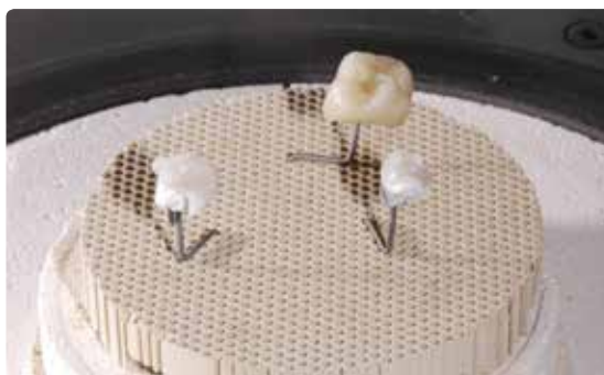
Effettuare la cottura supercolori e caratterizzazione sul portaoggetti a nido d'ape corrispondente al forno per cottura.
