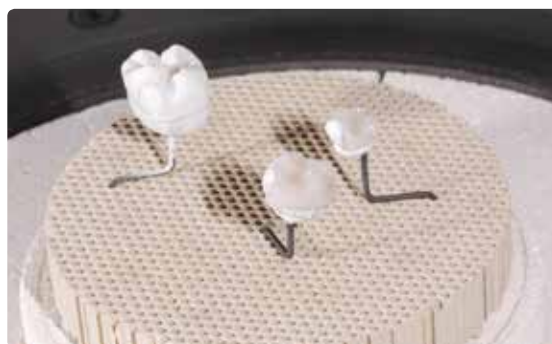
Effettuare la cottura di glasura su portaoggetti a nido d'ape con i relativi parametri di cottura.
