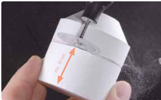
Separare con disco separatore il cilindro a distanza di 30 mm dalla superficie del fondo...
