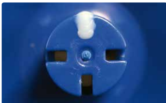
Chiudere con abbondante cera le fessure della base per cilindro non utilizzate.
