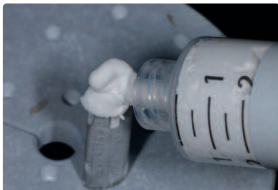
Applicazione di IPS Object Fix Flow o Putty su IPS e.max CAD Crystallization Pin.
