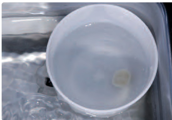
Rimuovere i residui con bagno ad ultrasuoni...
