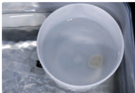
Eliminare i residui in bagno ad ultrasuoni...
